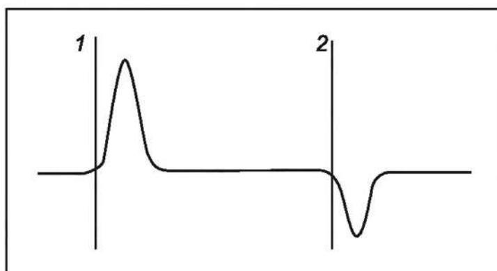
Примечание — Точка 1 (положение курсора 1) соответствует месту подключения кабеля к трубе или началу обследуемого участка трубопровода. В точке 2 (второй курсор) происходит полное отражение зондирующего импульса с изменением полярности — замыкание сигнального проводника на стальную трубу.
