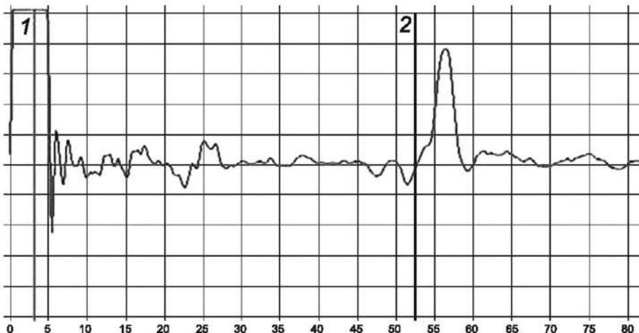
Примечание — Точка 1 (положение курсора 1) — место подключения кабеля к трубе или начало обследуемого участка трубопровода — соответствует расстоянию 3,17 м. В точке 2 (второй курсор) имеется резкое изменение волнового сопротивления и происходит полное отражение зондирующего импульса с сохранением полярности — обрыв сигнального проводника на расстоянии  $L = 49,4$  м.
