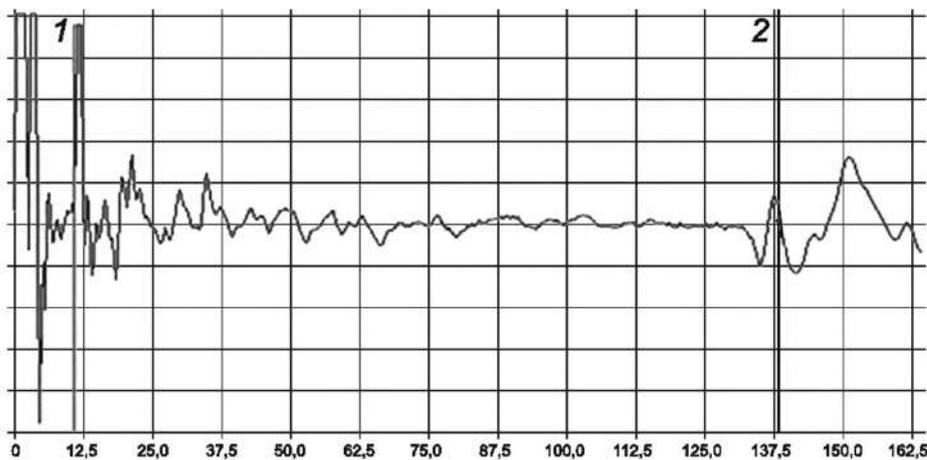
Примечание — Точка 1 (положение курсора 1) соответствует месту подключения кабеля к трубе или началу обследуемого участка трубопровода на расстоянии 10,88 м. Точка 2 (второй курсор) соответствует концу единичного участка и началу соединительного кабеля в данной точке.
