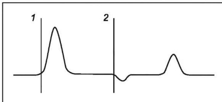
Примечание — Точка 1 (положение курсора 1) соответствует месту подключения кабеля к трубе или началу обследуемого участка трубопровода. В точке 2 (второй курсор) происходит отражение зондирующего импульса — намокание изоляции (намокание на рефлектограмме также идентифицируется как замыкание и отличается амплитудой) с последующим обрывом сигнального проводника.
