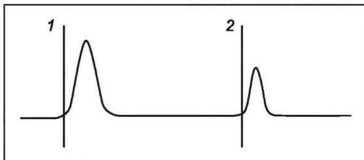
Примечание — Точка 1 (положение курсора 1) соответствует месту подключения кабеля к трубе или началу обследуемого участка трубопровода. В точке 2 (второй курсор) происходит резкое изменение волнового сопротивления и полное отражение зондирующего импульса с сохранением полярности — обрыв сигнального проводника.
