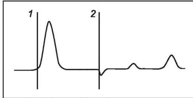
Примечание — Точка 1 (положение курсора 1) соответствует месту подключения кабеля к трубе или началу обследуемого участка трубопровода. В точке 2 (второй курсор) отрицательный импульс соответствует уменьшению волнового сопротивления.
